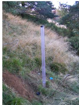
Test de perméabilité
